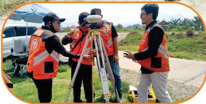
Menentukan titik GCP (Ground Central Point) dan ICP (Independent Check Point)
